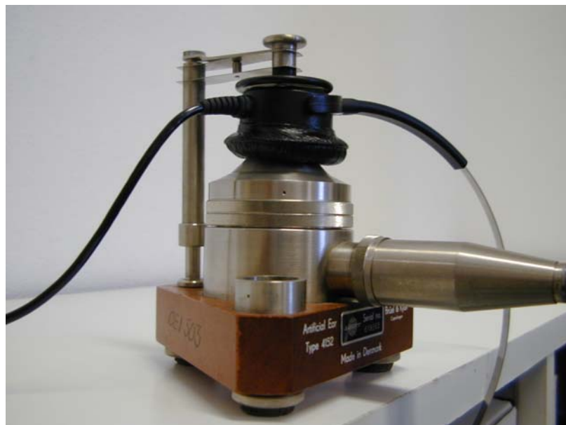
Figure 1 : oreille artificielle utilisée pour les mesures
